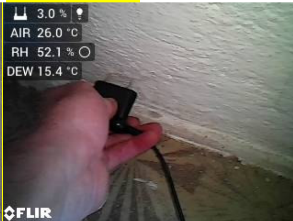
foto 50 1.11 chodba vlhkost 3 % hm
